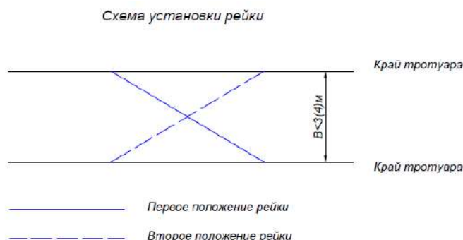
Рисунок 2– Измерение ровности в поперечном направлении (B- ширина тротуара, меньше длины рейки)
