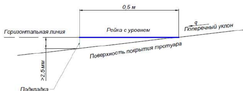
Рисунок 3 – Пример проверки поперечного уклона
